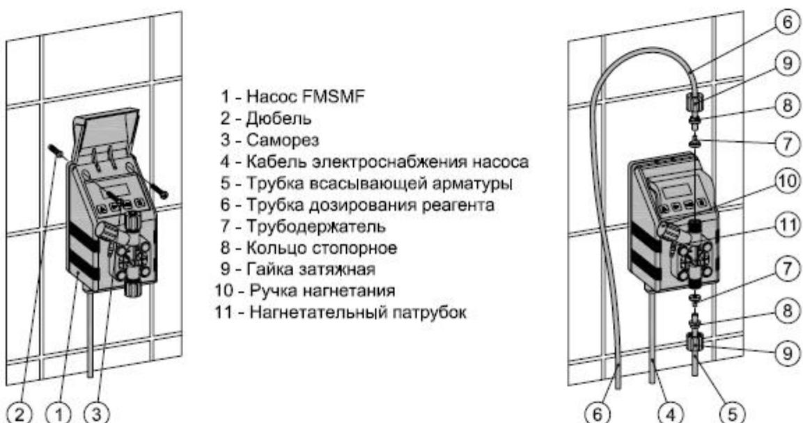
Рис.9 Установка мембранных дозирующего насоса FMSMF
