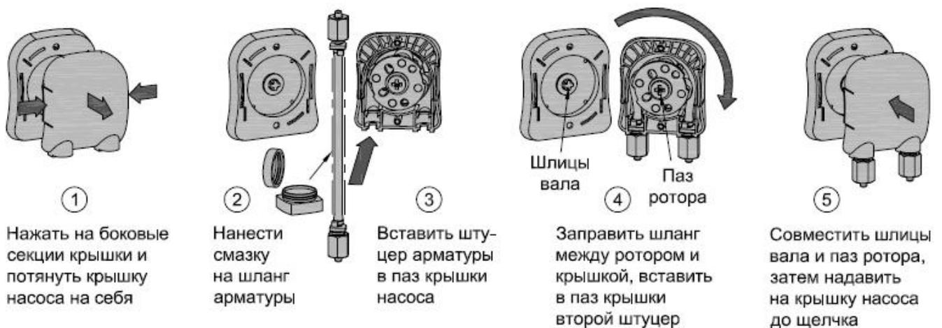
Рис.7 Установка шланговой арматуры в перистальтический насос
