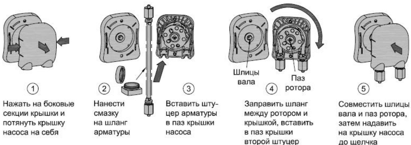
Рис.7 Установка шланговой арматуры в перистальтический насос
