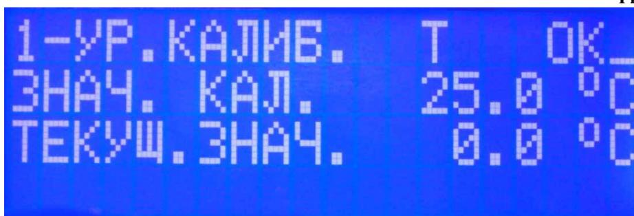
Подменю «1-Ур. КАЛИБРОВКА Т» позволяет произвести калибровку датчика температуры для Analyt и Pool Relax Oxygen Bayrol (126052). Калибровка представляет собой операцию «приравнивания» измеренного Автоматической станцией значения температуры воды бассейна к значению измеренному термометром.
