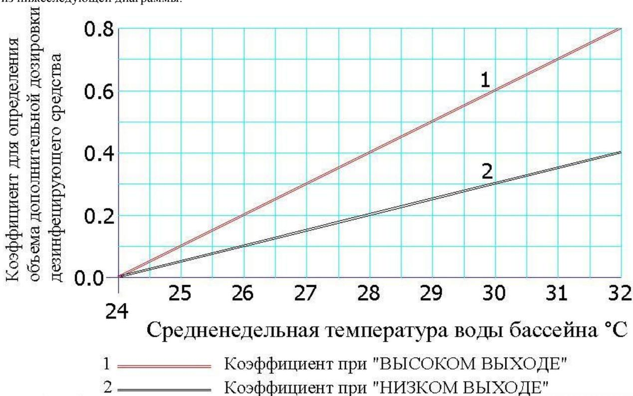
Объем КАЖДОЙ дополнительной дозировки дезинфицирующего средства равен объему основной дозировки умноженной на полученный коэффициент.
