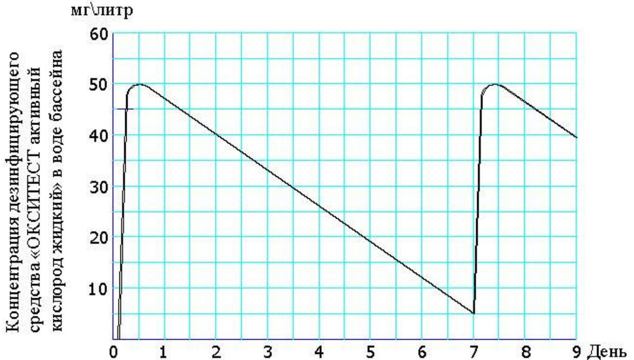
При температуре воды бассейна ниже или равной 24 °С возможна эксплуатация Автоматической станции с неактивной температурной компенсацией, тогда пиковая концентрация дезинфицирующего средства будет в день основной дозировки дезинфицирующего средства, далее концентрация будет снижаться до следующей основной дозировки (через неделю).
