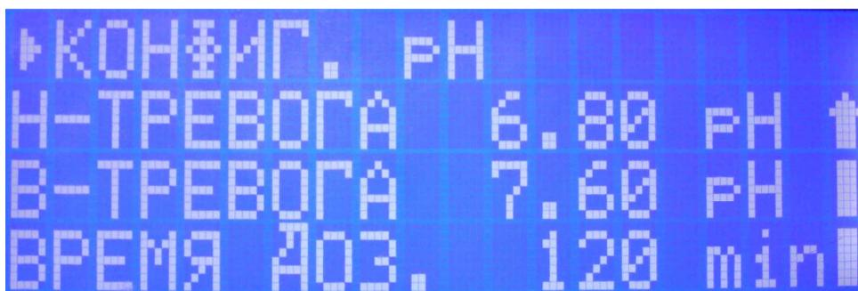
Подменю «НИЖНЯЯ ТРЕВОГА pH» показывает значение уровня pH воды бассейна при снижении уровня pH воды бассейна ниже этого значения, Автоматическая станция переходит в режим ТРЕВОГИ. При этом на дисплее появится надпись «В-ТРЕВОГА pH» и будет произведена блокировка насосов-дозаторов. Данная настройка позволяет предотвратить передозировку препаратов корректирующих уровень pH воды бассейна.
