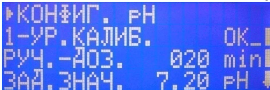
Меню «1-Ур. Калибровка рН» необходимо для одноуровневой калибровкой Зонда рН Вагол (185301/401) и представляет собой операцию «приравнивания» измеренного Автоматической станцией значения рН воды бассейна к значению, измеренному фотометром (спектрометрическим прибором) или другим способом обеспечивающим достаточно точное измерение
